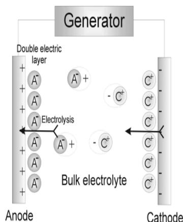
**Fig 4:** Conductometric Biosensor
