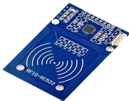
Fig-4: RC522 RFID reader Module
