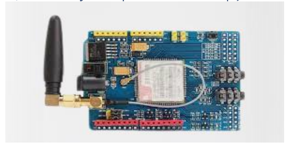
Fig 4.10 GSM Module 900A
