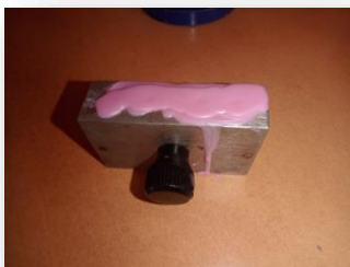
Fig:-5 Pour the formulation in mould
