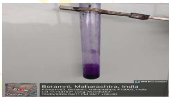
Fig 17 : Dirt dispersion test
