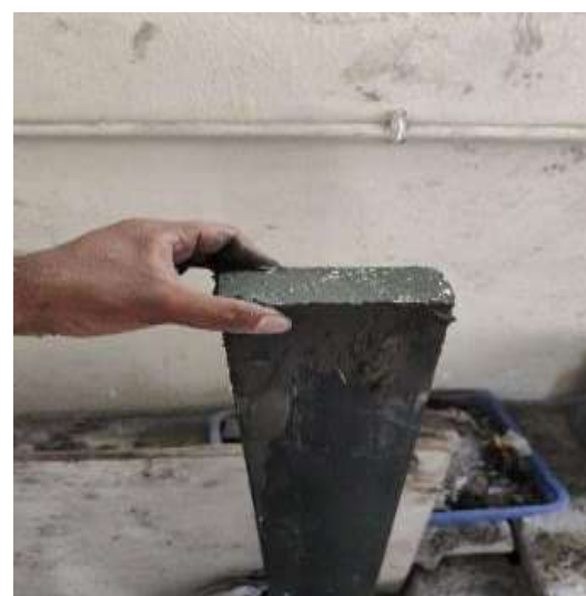
Fig.4.2 CFST Column Specimen (100mm×50mm×1000mm and 100mm×50mm×1500mm)
